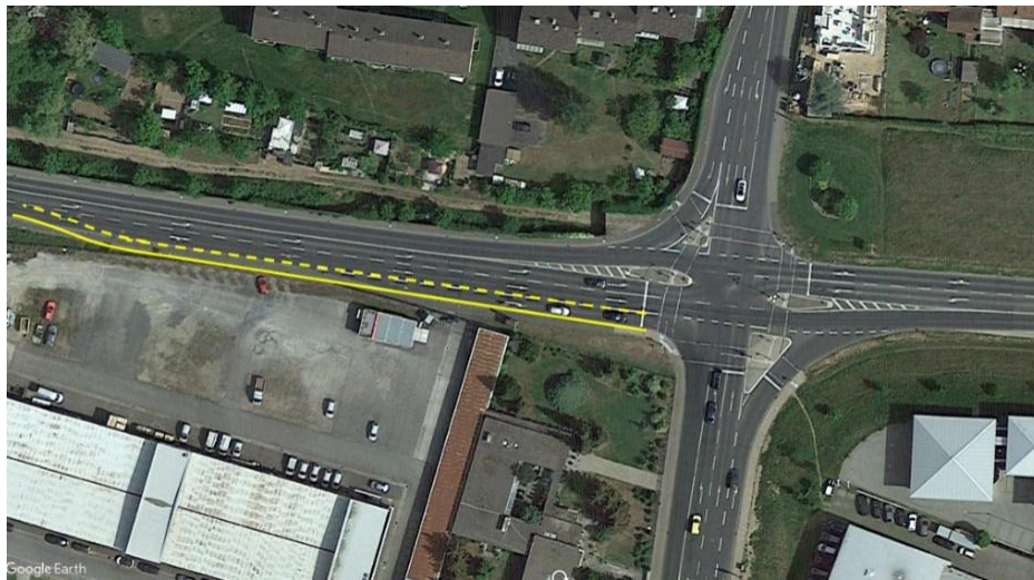
Abbildung 35: Maßnahme 2: Verlängerung der Rechtsabbiegespur bei K7
